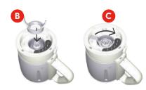
Inserir a alavanca na base da lâmina na parte inferior do copo, rode a alavanca no sentido horário até prender a lâmina.
